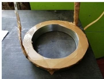
Рисунок 4 - Защита поверхностей кольца, не подлежащих нанесению покрытий
