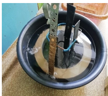
Рисунок 5 - Опытная установка для нанесения покрытий на детали
