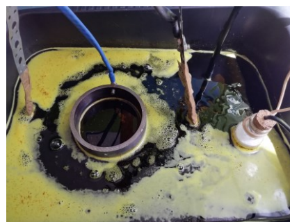
Рисунок 5 - Опытная установка для нанесения покрытий на детали
